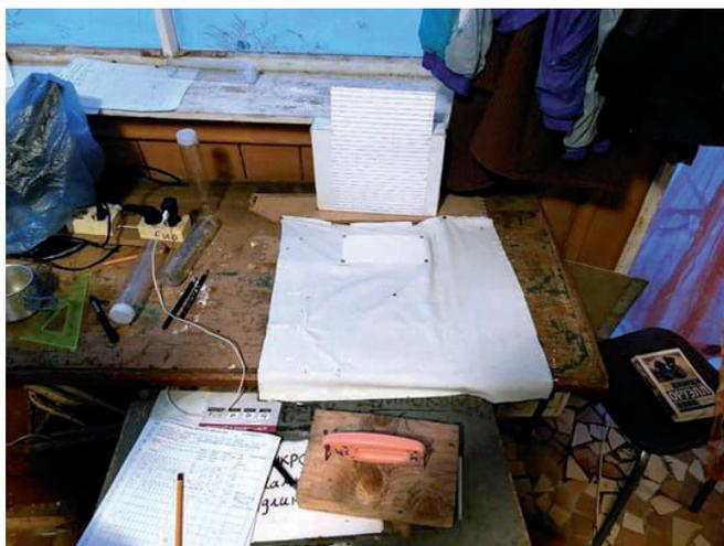
Рис. 3. Установка для съемки прыжков жуков. Сам жук выкладывался на белый приколотый булавками прямоугольник посреди полотна. На установку из ящичков (на место термометра) ставился телефон. Угол каждого элемента установки был выверен с помощью промышленного уровня.
